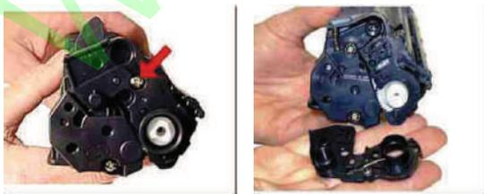
Mettez le tambour de côté et dévissez le capot se trouvant sur le côté de la chambre de remplissage. Vous pourrez ensuite enlever le rouleau de développement et le mettre de côté.
